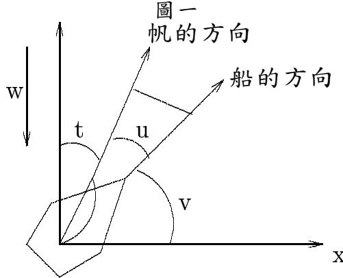
圖一為帆船的俯視圖， $w$ 代表風力，由正北方往南吹， $w$ 可分為  $w_1, w_2$  兩個分量， $w_1$  與帆的方向垂直， $w_2$  與帆的方向平行，如圖二所示，實際對帆有影響的力為  $w_1$ ，
