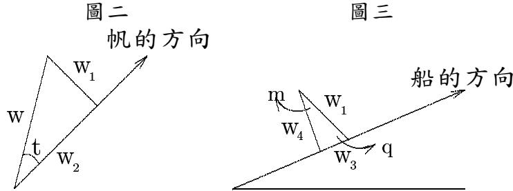
所以船受到的力為  $w_1$ 。 $w_1$  可分為  $w_3, w_4$  兩個分量， $w_3$  與船的方向平行， $w_4$  與船的方向垂直，如圖三所示，由於船的結構與水的阻力， $w_4$  能使船橫移的程度有限，在此忽略不計，所以真正能使船前進的力為  $w_3$ ，而  $w_3$  有往北的分量，此一分量越大，船往北速度的分量就越大，那麼究竟在  $t, u, v$  三個角的角度為何時， $w_3$  往北的分量會最大呢？
