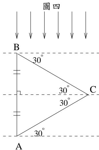
如果要最快到達 $B$ 地，則船所受到往北的分力在任何時刻都必須是最大的，則 $t = u = v = 30^\circ$ ，船頭往東偏北 $30^\circ$ 或是往西偏北 $30^\circ$ ，最簡單的一個方法便是從 $A$ 點往東偏北 $30^\circ$ 出發，到達 $AB$ 中垂線上的 $C$ 點，再折往西偏北 $30^\circ$ 前進，就可用最短的時間到達 $B$ 了。(此為風向皆由正北朝正南吹的情形)。
