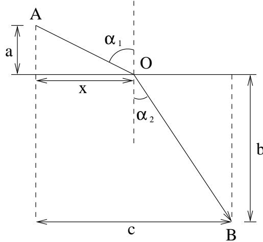
小球由A到O的速度是 $V_1$ ，由O到B的速度是 $V_2$ ，則從A到B所花的時間
