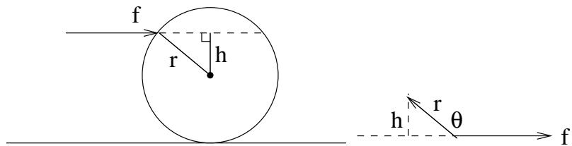
3. 要達到全滾動而不滑動，則  $\int f(t)dt$ ，動量的變化率最後必須全部轉變為  $MV_{cm}$ ，瞬間達成。
