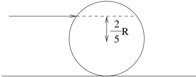
補充：為何滾動而不滑動的時候會有  $V_{cm} = \omega R$ ? ∵ 滾動而不滑動 ∴ 質心的位移等於弧長  $\Rightarrow s = R\theta, \Rightarrow V_{cm} = \frac{ds}{dt} = \frac{Rd\theta}{dt} = R\omega$
