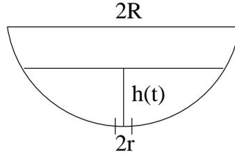
如上圖，水面高  $h(t)$  時，水從底部要漏出的速率為  $\sqrt{2gh}$ ， $(\frac{1}{2}mv^2 = mgh, v = \sqrt{2gh})$ ，設水的體積是  $\bar{V}$ ， $\frac{d\bar{V}}{dt} = -\pi r^2 \sqrt{2gh}$ ， $\frac{d\bar{V}}{dh} \cdot \frac{dh}{dt} = -\pi r^2 \sqrt{2gh}$  (Chain Rule)
