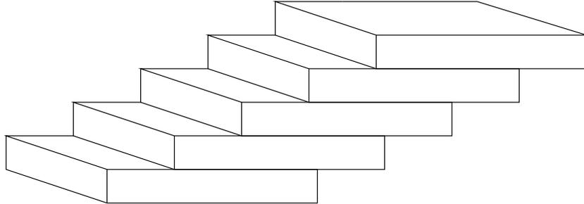
解：最大差距發生在：從上方算下來總共 $k$ 塊木板的重心剛好落在從上方算下來第 $k+1$ 塊木板的最右端。如果最大差距的堆法不滿足上述，即對某個 $k$ ，上方算下來總共 $k$ 塊木板的重心，在上方算下來第 $k+1$ 塊木板最右端的左側，此時可將第 $k+1$ 塊木板向左移動 $l$ ，上方 $k$ 塊木板向右移動 $\frac{l}{k}$ ， $l$ 取夠小使得上方 $k$ 塊木板的重心仍然不超過 $k+1$ 塊木板的最右端，此時一方面這 $k+1$ 塊木板的重心維持不變，所以不會導致倒塌，而最上和最下的木板的差距可以變得更大。
