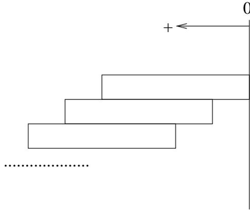
現在計算這最大差距的值，假設木板側面的長為2，定最上一塊木板的右端水平坐標為0，左方為正向， $a_k$ 代表上方第k塊木板重心的水平坐標，則  $a_1 = 1, a_2 = a_1 + 1 = 2, a_3 = \frac{a_1 + a_2}{2} + 1 = \frac{5}{2}, \dots$
